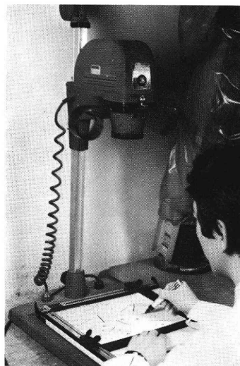
上の方式で撮影したフィルムを拡大し、紙上でトレースする
