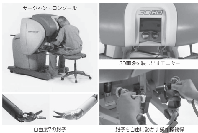
(図 D-3-6)-2) da Vinci® surgical system の特性
